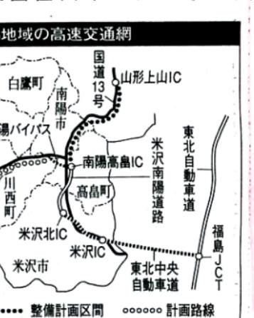
一方、新潟山形南部連絡道路は新潟～富賀～仙台間を結ぶ「横軸」の地域高規格道路として計画された。東北中央道南陽高畠ICと日本海東北自動車道の荒川IC（仮称）を結び、延長は約80キロ。計画路線のうち、山形河川国道事務所は国道113号赤湯バイパスの整備を進めている。全区間を高盛り土方式で整備し、国道13号と県道2号所の計三カ所に立体交差のI.C.を設ける。南陽市鍋田～高畠町深沼間「一・二」は〇三年に一部開通。今後は南陽市島貫～鍋田間「二・一」が〇八年度に開通する見通しだ。赤湯バイパスが完成すると、南陽市内をノンストップで横断できるようになり、高畠町から公立置賜総合病院（川西町）までの所要時間は、現在の二十九分から二十一分へと約八分間の短縮が見込まれる。
